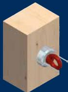
Anschließend wird der IdeFix® IFS so am Holz ausgerichtet, dass die Ringschraubenöffnung im rechten Winkel zur Belastungsrichtung steht und zwei Systemschrauben (unter 90°) gesetzt. Danach wird die Ringschraube wieder herausgedreht.
